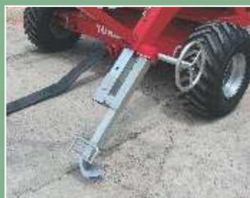
Redutor mecânico para levantar das âncoras e sistema de entrada de água pelo chassi
